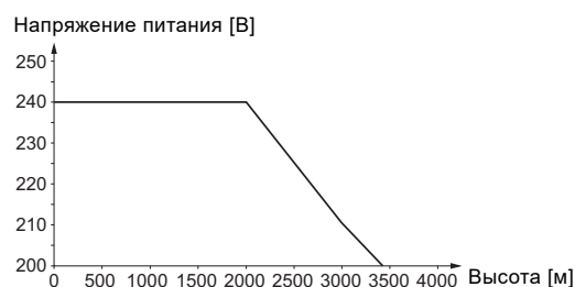
Рис. 6 Зависимость напряжения питания однофазного электродвигателя от высоты над уровнем моря
