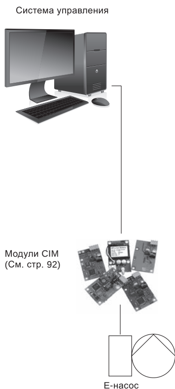
Рис. 12 Структура центральной системы управления
